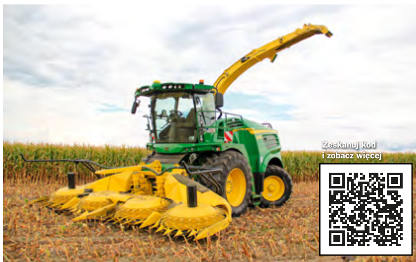
Najnowsza sieczkarnia samojezdna John Deere z serii 8000. Na rurze wyrzutowej zamontowano czujnik HarvestLab, który mierzy zawartość suchej masy i składników pokarmowych w zielonce
