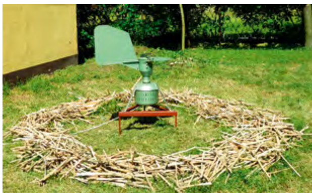
Pułapka typu Hirsta służąca do oznaczenia stężenia zarodników w powietrzu
